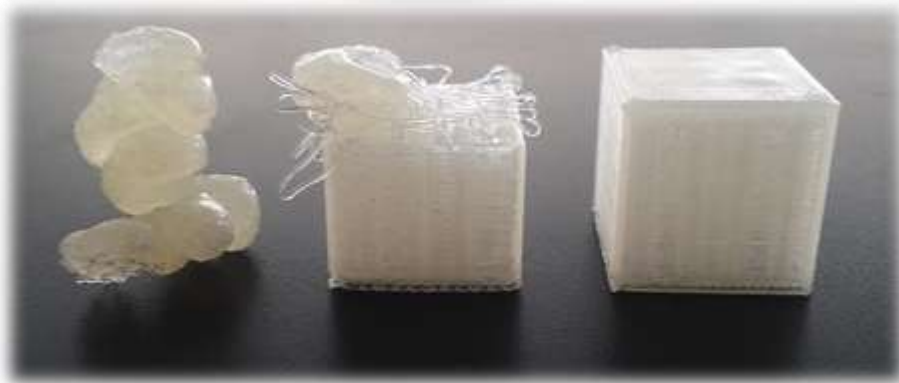
Figura 4.11. Variabilidad del proceso debida a factores no vinculados con los parámetros de fabricación
