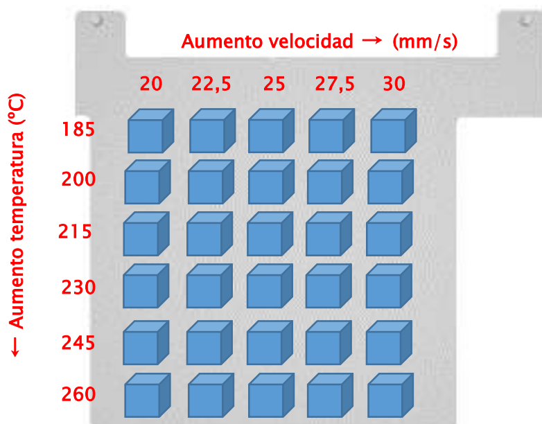
Figura 3.7. Disposición de las probetas para proceder a su fabricación
