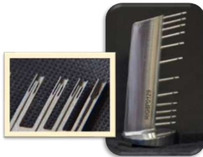
Figura 2.32. Modelo de tubos interiores y Rake integral fabricado por sinterizado láser selectivo SLS [8]
