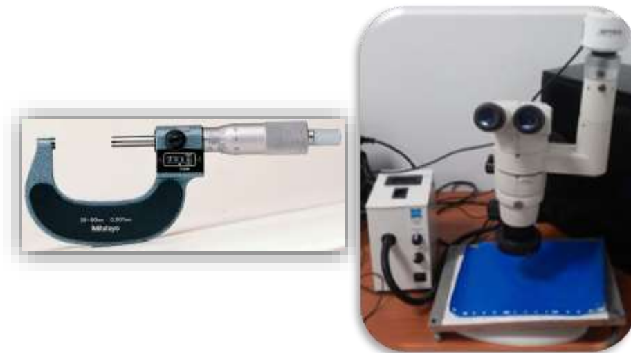
Figura 3.8. Equipo de evaluación macrogeométrica utilizado: a la izquierda micrómetro; a la derecha microscopio estereoscópico [15]
