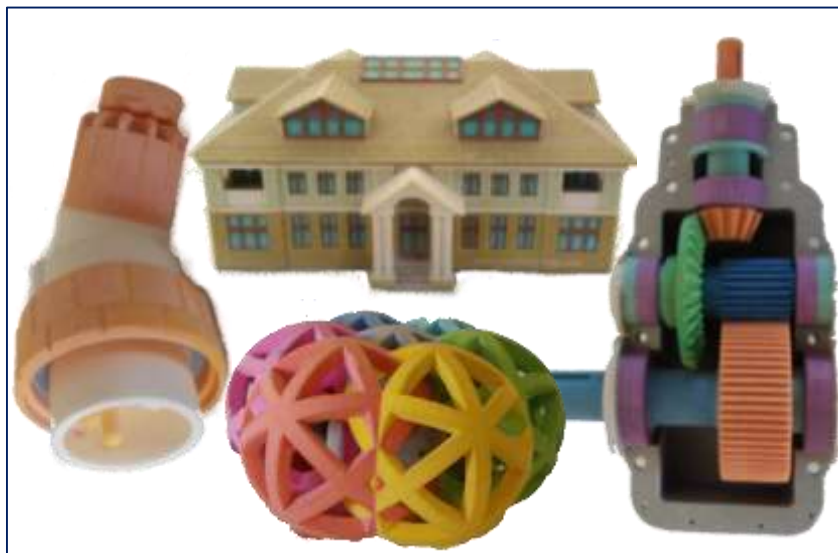
Figura 2.10. Ejemplos de piezas fabricadas mediante 3D-Printing.
