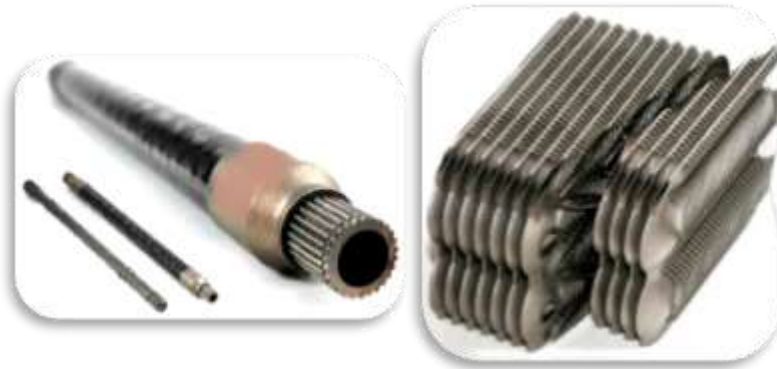
Figura 2.33. (a) Eje de transmisión y (b) intercambiador de calor de un “Formula student” [100]
