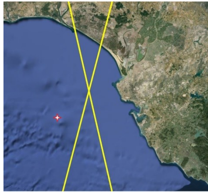
Figura 1. Trazas ascendente y descendente del paso del satélite en la zona de estudio y posición de la boya.
