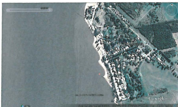
FIGURA 4. Ídem que la Fig. 3 pero en 2012. El cambio de color azul claro al oscuro coincide con la transición de la pendiente suave de la orilla al cauce. Se aprecian también los frentes de onda provenientes del sur y el cambio de dirección por refracción.
