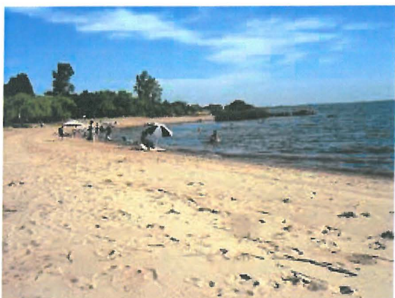
FIGURA 2. Turistas aprovechando la escasa pendiente del perfil inferior de la playa. Se aprecia la curva de la costa inducida por la difracción del espigón ubicado al fondo.
