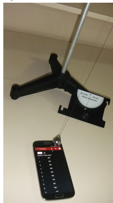
Figura 2. Montaje experimental del péndulo simple para calcular el valor de g .
