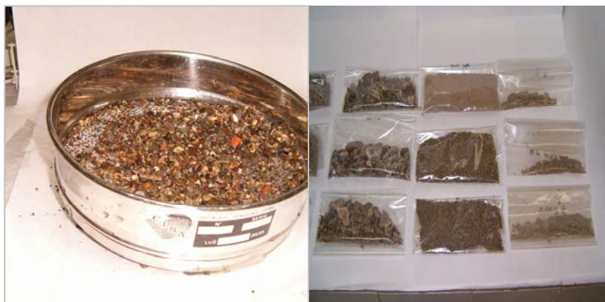
Figura VI.12. Fraccionamiento de la muestra en grava, arena y limo+arcilla
