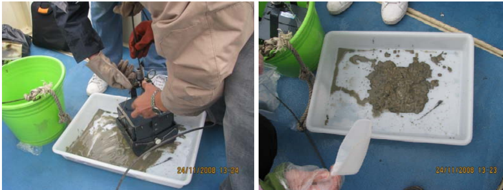
Figura VI.8. Toma de muestras de sedimento en la costa de Tánger (punto A)
