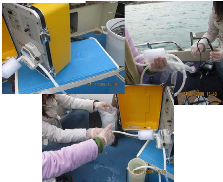
Figura VI.11. Filtración de las muestras de agua y medidas de parámetros “in-situ” en la costa de Tánger
