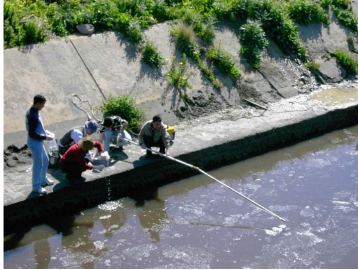
Figura VI.9. Empleo del sistema de pértiga para la toma de muestra (Punto H)
