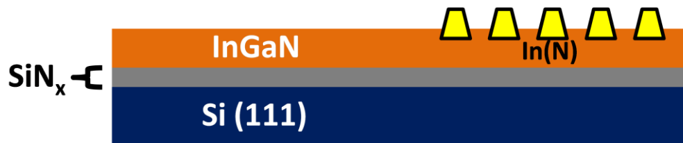
Figura 3. Esquema genérico de las heteroestructuras caracterizadas. El estudio se centrará en las capas crecidas por MBE ( \text{SiN}_x , InGaN, In y/o InN, el substrato es una oblea comercial).
