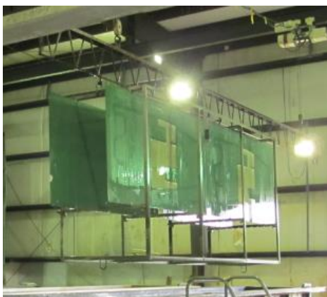
Figura 12. Sistema de agarre de piezas por marco único. [20].
