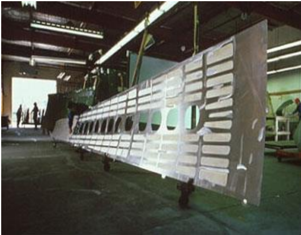
Figura 7. Parte del fuselaje de un avión cuyo peso ha sido aligerado por FQ.
