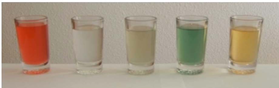
Figura 8.- Algunos de los colores que adquiere el extracto de rosa al cambiar el pH. El pH de la disolución aumenta hacia la derecha.
