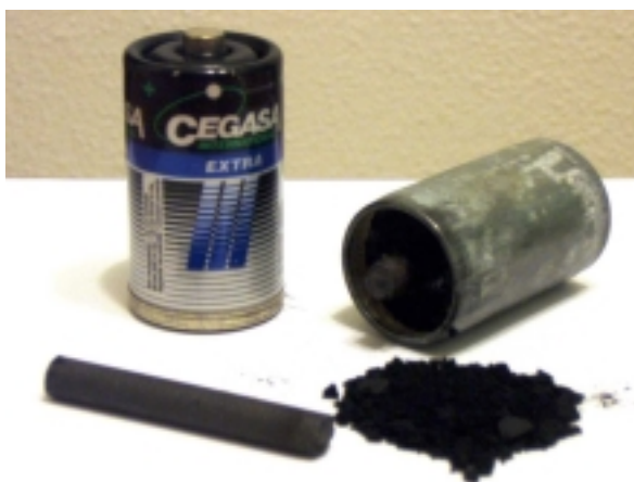
Figura 13.- Partes que componen una pila salina: el recipiente de zinc, el electrodo de carbono y el polvo de dióxido de manganeso.
