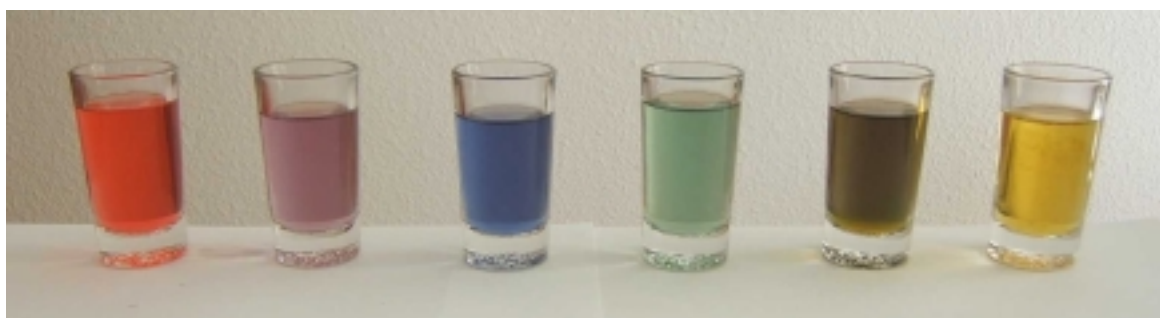
Figura 7.- Algunos de los colores que adquiere el extracto de col lombarda al cambiar el pH. El pH de la disolución aumenta hacia la derecha.
