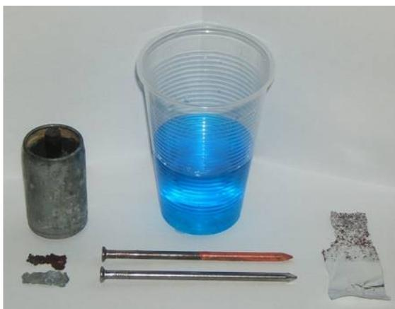
**Figura 6.** De izquierda a derecha: trozos de cinc de una pila salina, clavos de hierro y un trozo de papel de aluminio. Delante se muestran los metales sin recubrir, detrás los metales recubiertos de cobre.
