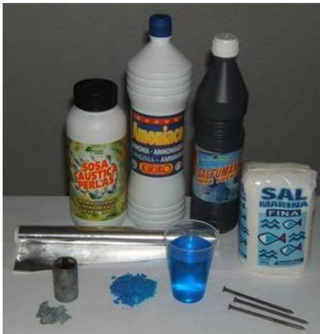
**Figura 1.** Reactivos usados en las experiencias que se detallan en este trabajo: cinc de una pila salina, papel de aluminio, sulfato de cobre, clavos de hierro, sosa cáustica (NaOH), amoníaco (NH<sub>3</sub>), sulfamant (HCl) y sal común (NaCl).
