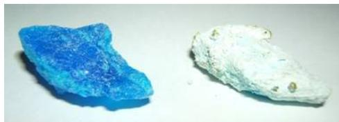
**Figura 9.** A la izquierda, sulfato de cobre pentahidratado; a la derecha sulfato de cobre anhidro.
