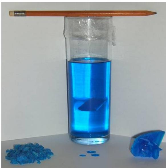
**Figura 2.** Dentro del vaso se observa un cristal triclinico de sulfato de cobre creciendo en una disolución sobresaturada de dicha sal. Delante del vaso y de izquierda a derecha: aspecto inicial del sulfato de cobre, tres cristales triclinicos, a partir de los cuales se puede crecer un cristal gigante, y un cristal gigante que ha crecido durante dos días.
