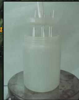
*Celdas de microextracción en fase líquida utilizadas. (izquierda) unidad contenidos totales de níquel, (derecha) unidad especiación de níquel*
