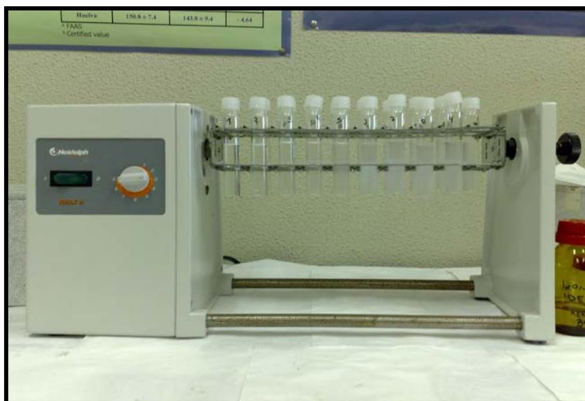
**Figura II.5.** Agitador de tubos utilizado para los procesos de extracción y reextracción.
