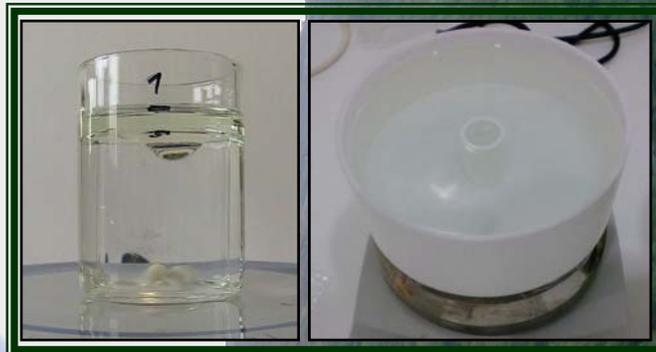
*Celdas de membrana líquida de volumen utilizadas. (izquierda) celda de vidrio, (derecha) celda de teflón.*
