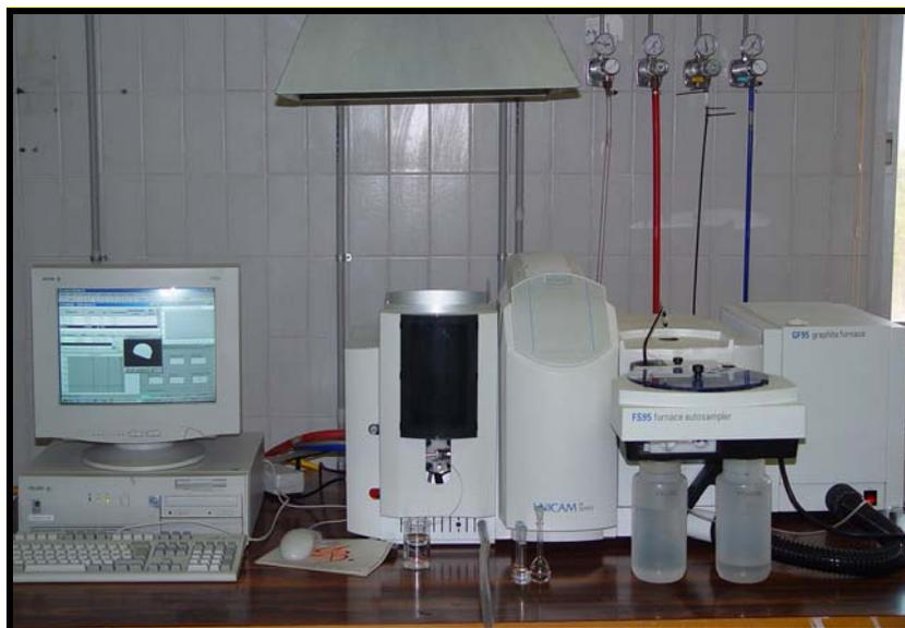
**Figura II.6.** Espectrómetro de absorción atómica utilizado para medir la fase acuosa.
