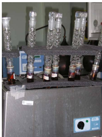
Figura 2: Probetas + Condensador Vigreux en el ultrasonido en el segundo ensayo
