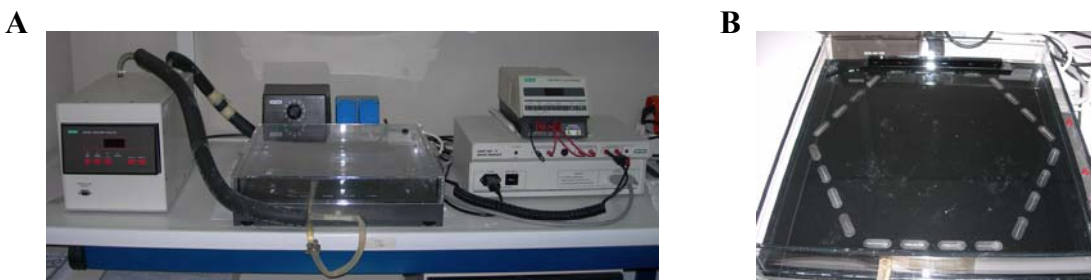
Figura 10. A) Equipo CHEF-DR II utilizado para realizar la Electroforesis en Campo Pulsante en el que se muestra de izquierda a derecha la unidad de frío, cubeta de electroforesis y la fuente. B) Disposición hexagonal de los electrodos dentro de la cubeta de electroforesis.
