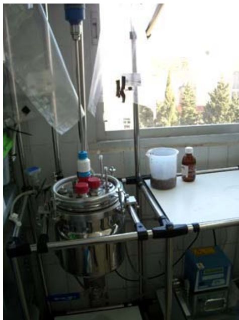
Fig 84. Reactor tipo tanque agitado para el desarrollo de los ensayos semicontinuos con FORSU en termofílico y mesofílico
