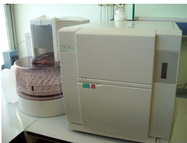
Fig 29. Analizador de carbono orgánico TOC5050A con automuestreador.
