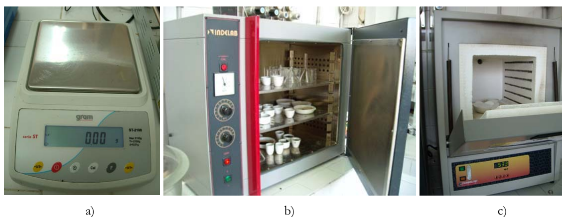
Fig 28. Equipos para el análisis de ST y SV: a) Balanza de precisión, b) Estufa y c) Horno mufla
