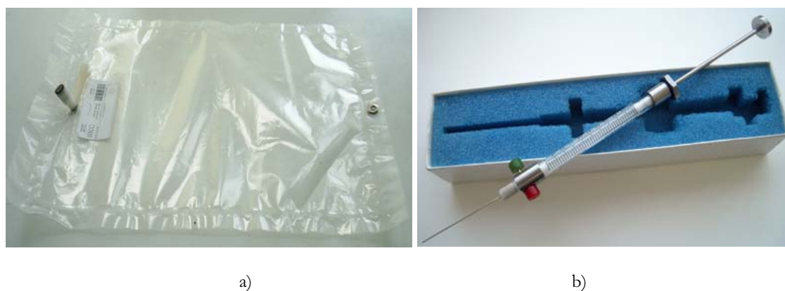
Fig 36. a) Bolsa Tedlar empleada en la recogida de biogás de los ensayos, b) Jeringa especial para gases.
