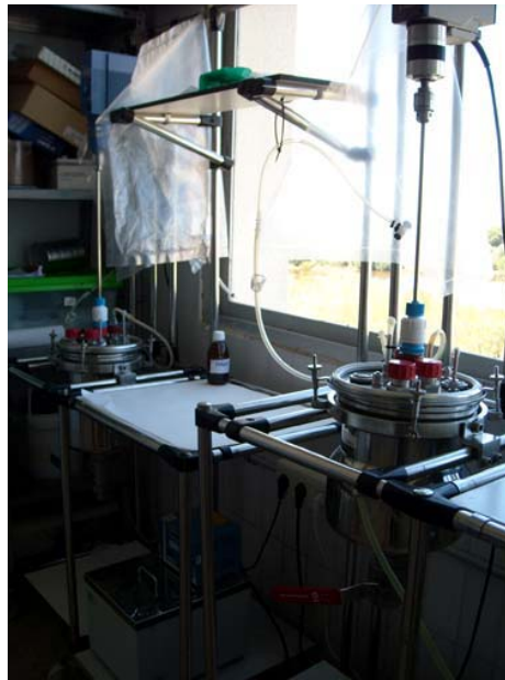
Fig 108. Reactores tipo tanque agitado para el desarrollo de los ensayos semicontinuos con FORSU en termofílico y mesofílico
