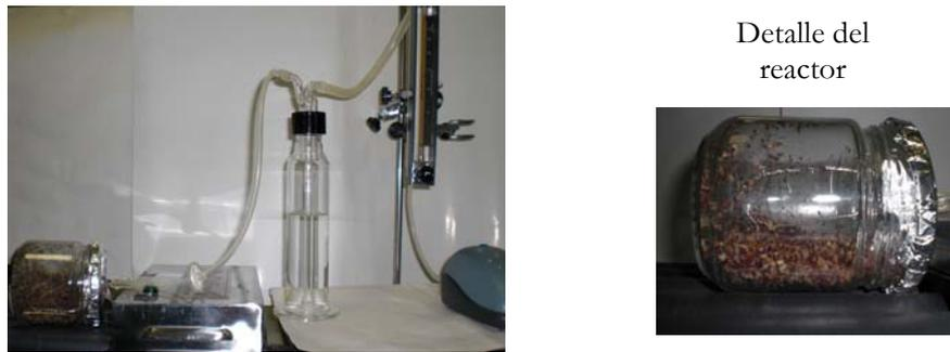
**Figura 4.10: Fotografía del reactor de tambor rotatorio.**
