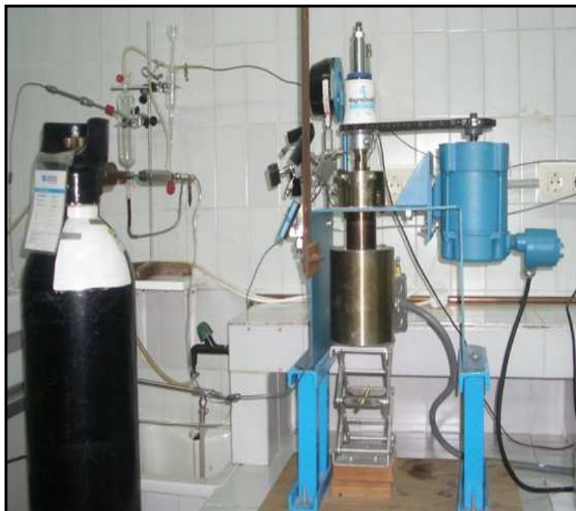
Figura 31. Fotografía general del equipo para operación en discontinuo.
