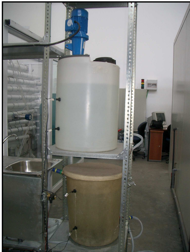
Figura 37. Fotografía de los tanques de alimentación de la primera línea.
