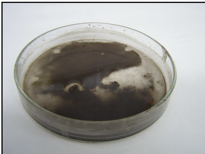
Figura 123. Segunda fracción obtenida de los residuos de vinazas a la salida de los precalentadores eléctricos en el atasco del sistema.
