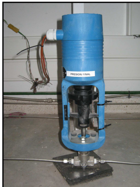
Figura 52. Fotografía de la electroválvula reguladora de presión.
