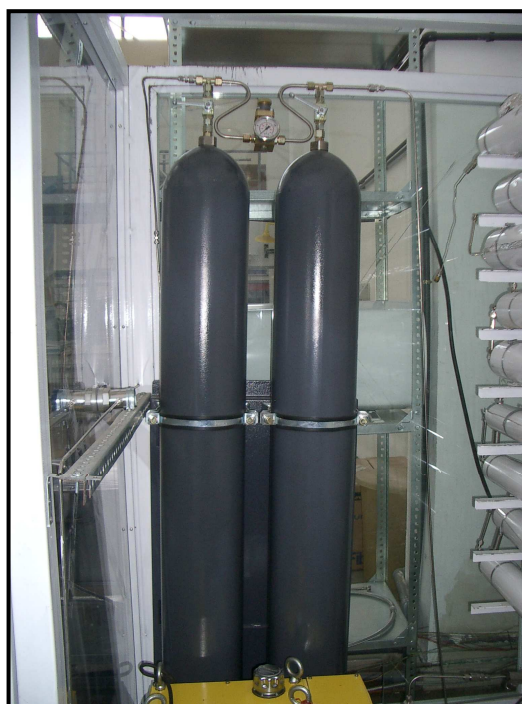
Figura 41. Fotografía de las botellas de almacenamiento de aire a presión.
