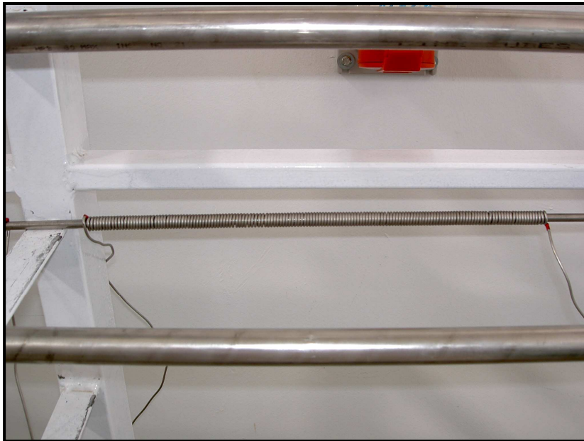
Figura 45. Fotografía de una de las resistencias bobinadas alrededor de una tubería de 1/4”.
