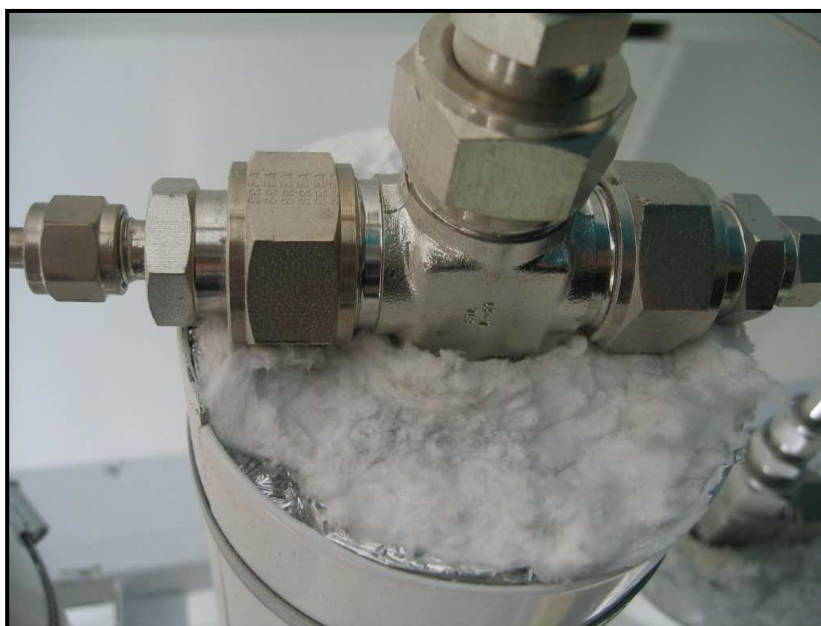
Figura 48. Detalle del aislamiento térmico.
