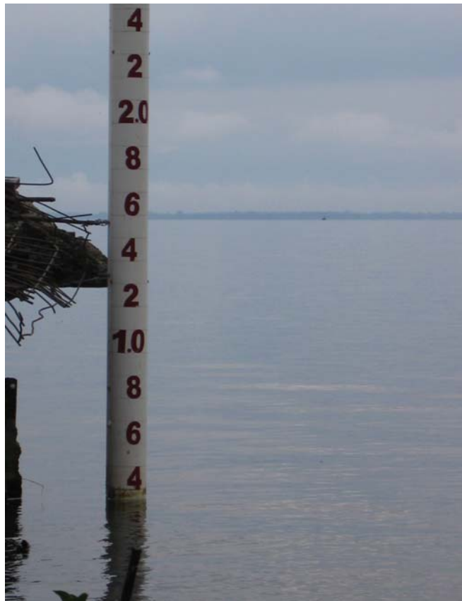
Figura A.1. Instrumento utilizado para medir las variaciones de nivel de agua del Lago de Izabal
