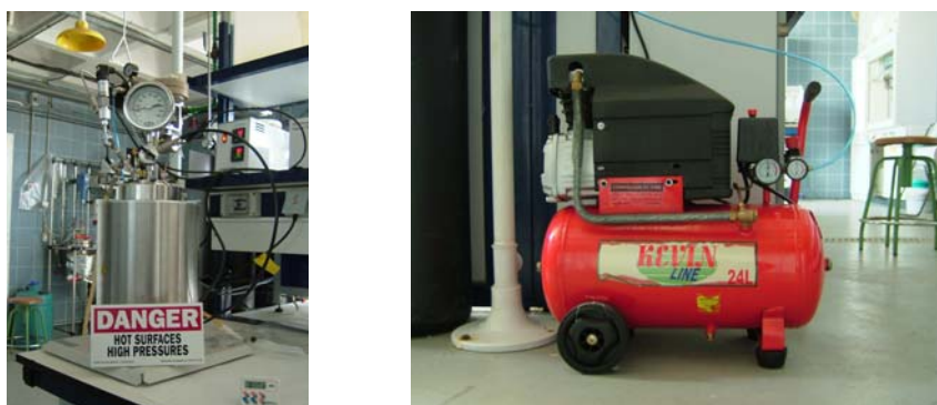
FIG. V.1. Reactor a presión para pretratamientos termoquímicos; Compresor para el accionamiento de la válvula neumática
