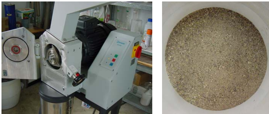
FIG. A.2. Molino empleado para la molienda y residuo triturado
