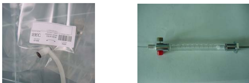
FIG. A.9. Jeringa y bolsa Tedlar empleada en la recogida de gases de los ensayos discontinuos
