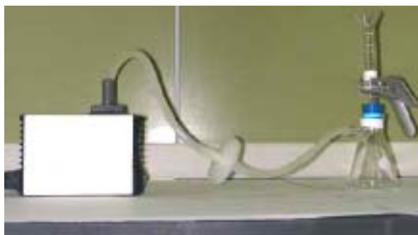
FIG. V.6. Equipo de filtración conectado a una bomba de vacío Millipore
