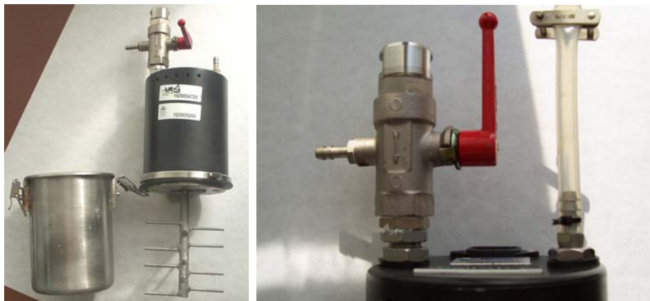
FIG. VI.1. Batería de reactores discontinuos de tanque agitado: detalle de las aspjas y de la válvula tres vías
