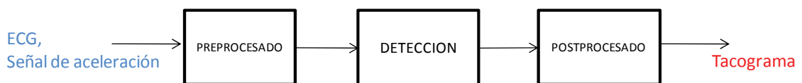
Figura 68. Procesado general de la señal ECG y de la señal de aceleración para la obtención de la serie RR libre de errores
