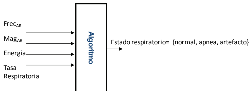
Figura 59. Parámetros de entrada y salida para el algoritmo de detección de eventos de apnea en la señal de acelerometría
