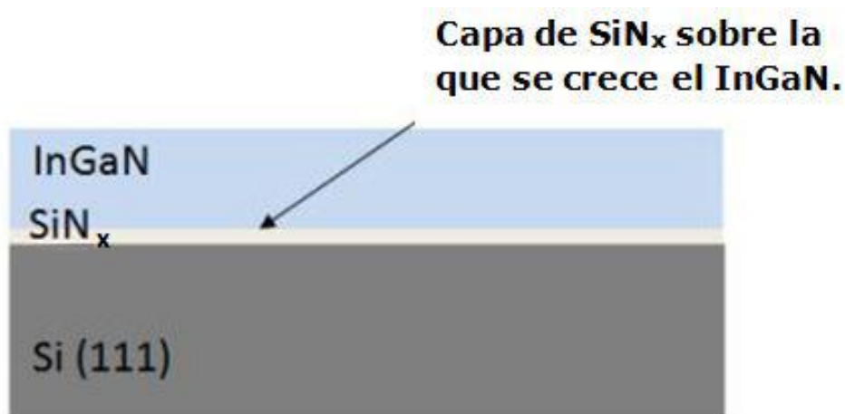
Figura 3: Esquema de la estructura caracterizada. Únicamente carecerá de interés en este estudio la masa del volumen del sustrato sobre el que se crece el material por PAMBE ( oblea de silicio (111) comercial).
