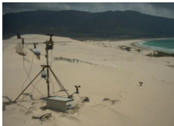
FIGURA 2. Vista de la torre de anemómetros en la cresta dunar.
