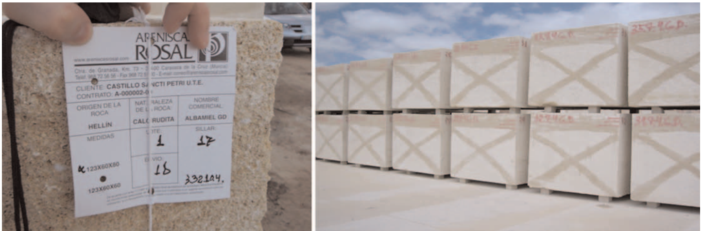
Fig. 14. Clasificación de bloques en cantera y etiquetado en obra.
