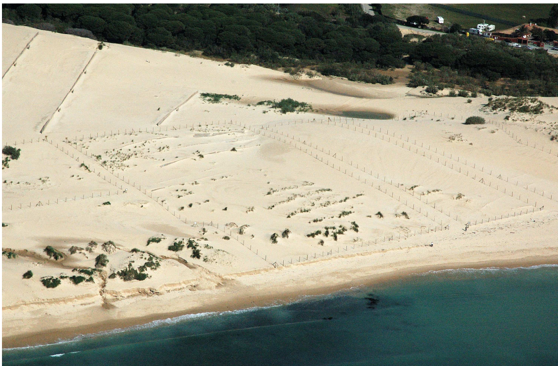
Fig. 3.34. Estado actual de los sistemas de captación en el pie de duna en Abril 2010 (Fuente: Demarcación de Costas en Andalucía-Atlántico)
