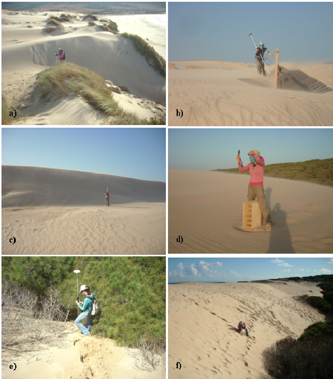
Fig. 4.3. Varias imágenes de diferentes campañas de tomas de datos: a) Topografía en dunas primarias; b) Topografía en la cresta dunar; c y e) Topografía en las caras de sotavento; d) Instalación de la trampa de arena; f) Recogida de muestra de sedimento en la cara de avalancha
