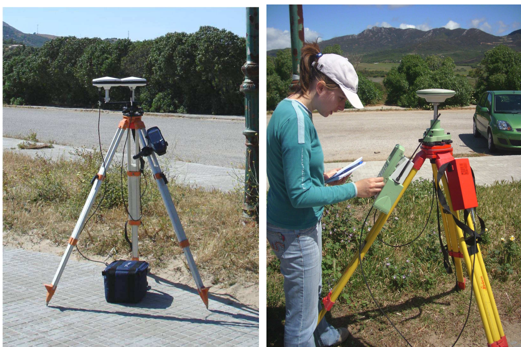
Fig. 4.2. Estacionamiento de dos tipos de GPSD en un punto determinado del aparcamiento de la playa de Valdevaqueros, durante diferentes campañas; a) Thales; b) Leica 1.200
