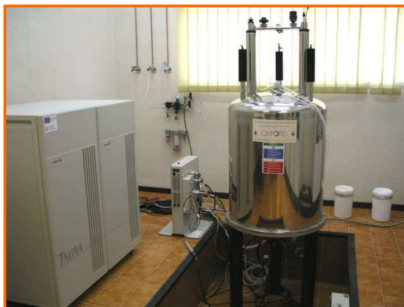
Figura 30: Equipo de RMN Varian (Inova-400). Servicios Centrales de Ciencia y Tecnología de la Universidad de Cádiz.
