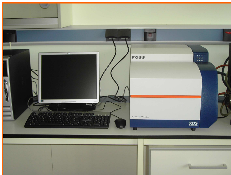
Figura 29: Equipo de espectroscopia de reflectancia en el infrarrojo cercano (NIRS) FOSS XDS Rapid Content™ Analyzer.
