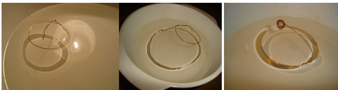
Figura 6. Arreglo experimental para medir la fuerza F.
