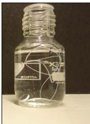
Figura 3-18. Sistema de membrana líquida soportada utilizado.
