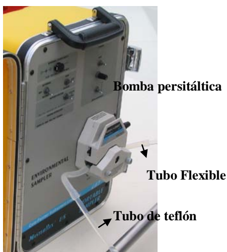
Figura 4-18. Bomba peristáltica utilizada en el muestreo
