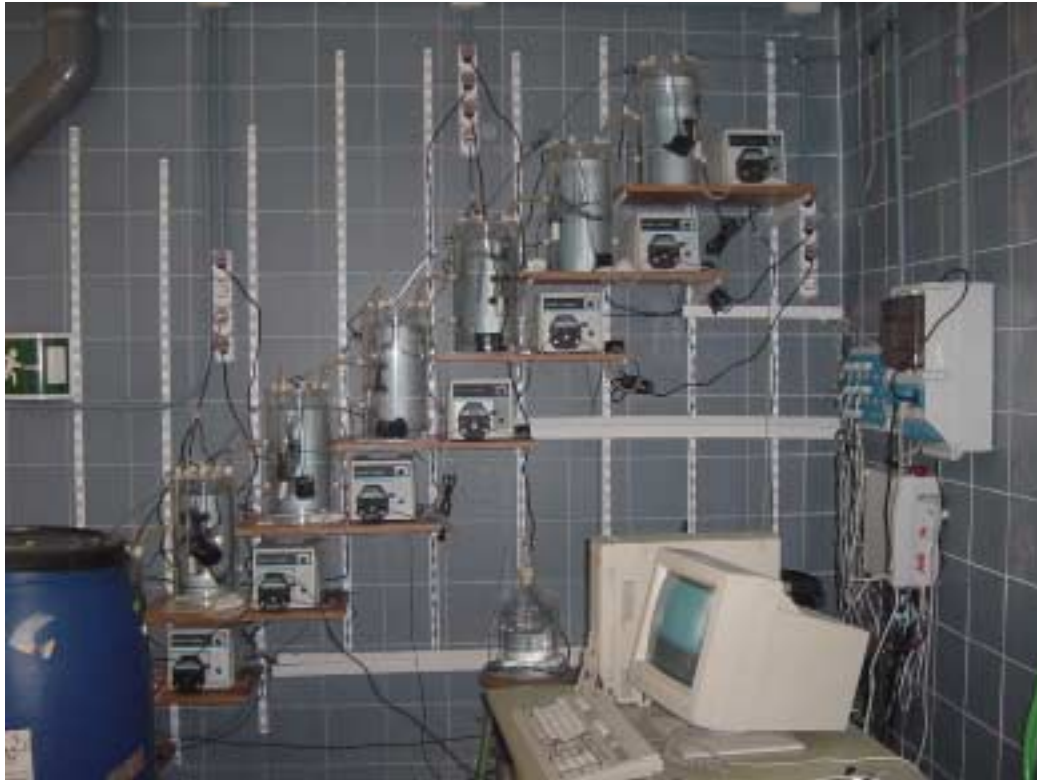
Figura 2.4. Vista general del simulador de estuarios.
