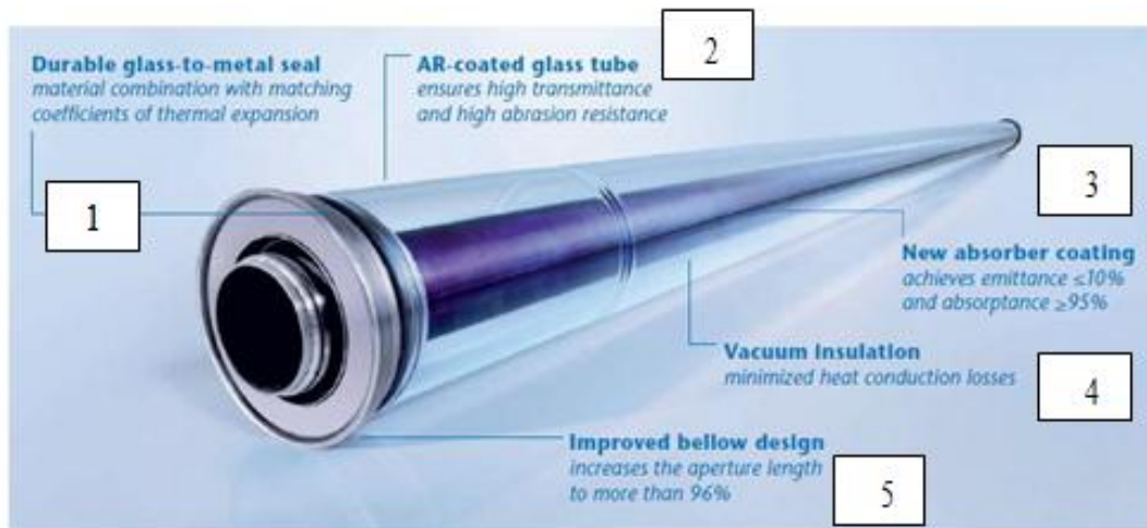
Ilustración 56. Tubo absorbedor SCHOTT PTR 70. (Fuente: Schott, 2010)
