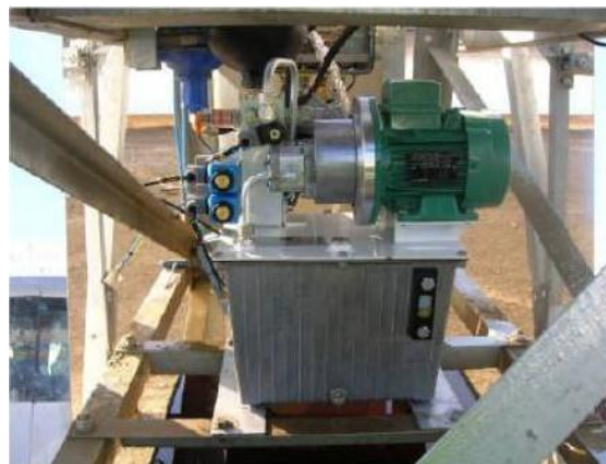
Ilustración 61. Unidad hidráulica sistema seguimiento.
