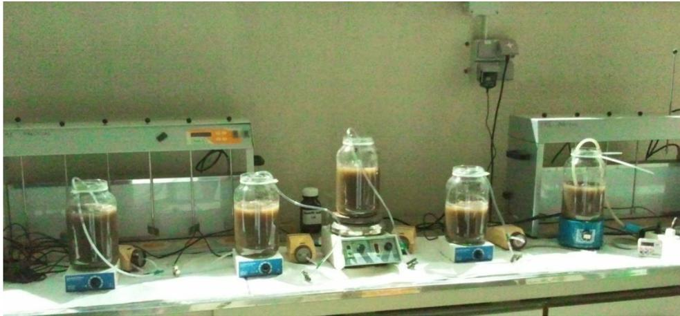
*Figura 3.1-Sistema de cinco reactores en discontinuo.*
