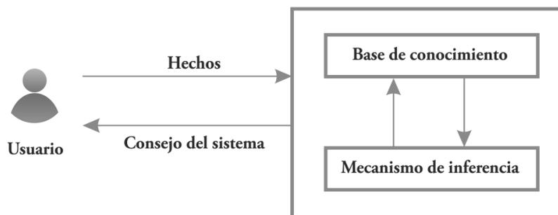
Figura 2.5: Esquema conceptual de un sistema experto
