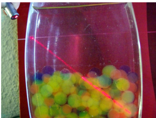
Figura 4. Un haz de luz láser atraviesa un recipiente con agua y bolas del polímero. Cada segmento visible corresponde a una de las bolas de polímero.
