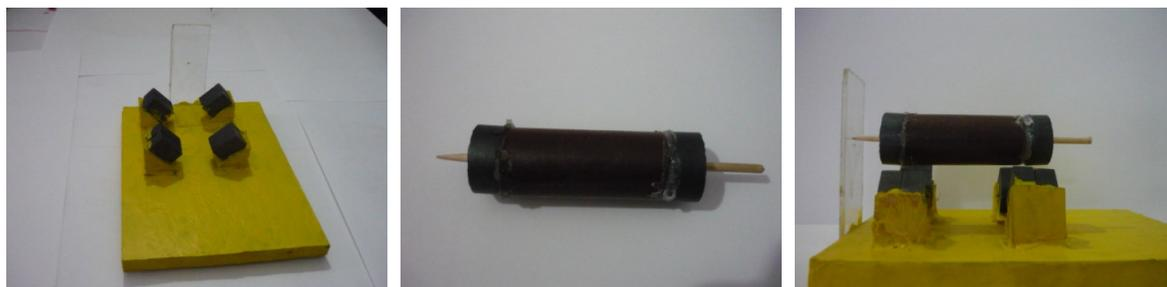
**Figura 6.** (Izq.) Disposición de los imanes en la base. (Centro) Pluma levitante. (Der.) Vista lateral de la pluma levitante en funcionamiento.
