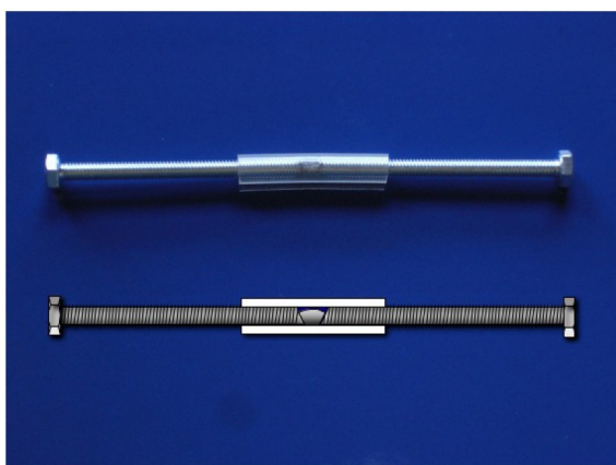
Figura 4. Cohesor. Dos tornillos, con los extremos biselados y roscados en un tubo de vinilo, comprimen una pequeña cantidad de limaduras de hierro.
