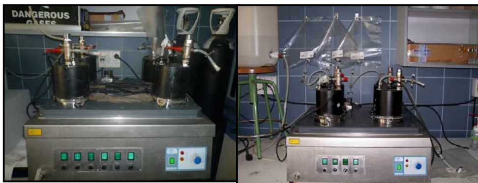
Imagen N° 3.3: Batería del baño mesofílico (izquierda) y termofílico (derecha) utilizados para el ensayo de biodegradabilidad con agitación.
