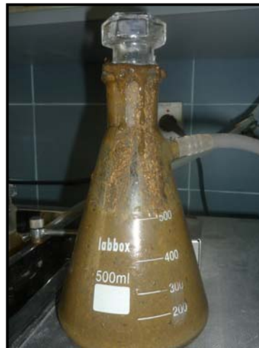
Imagen N° 4.1: Problemas de esponjamiento producidos en el ensayo M-75EV-25LE .
