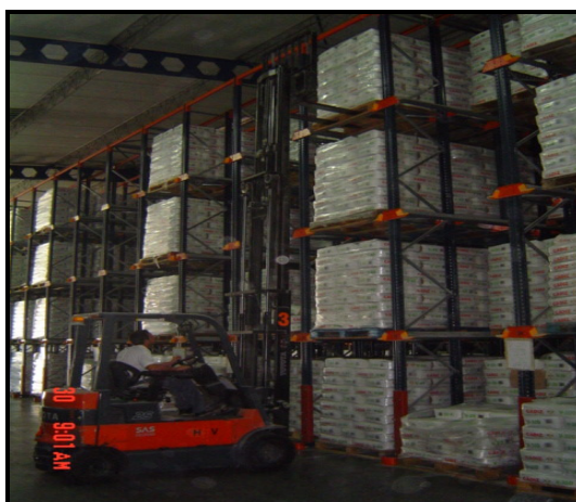
Figura 3.6. Transporte de palets a las estanterías rack.
