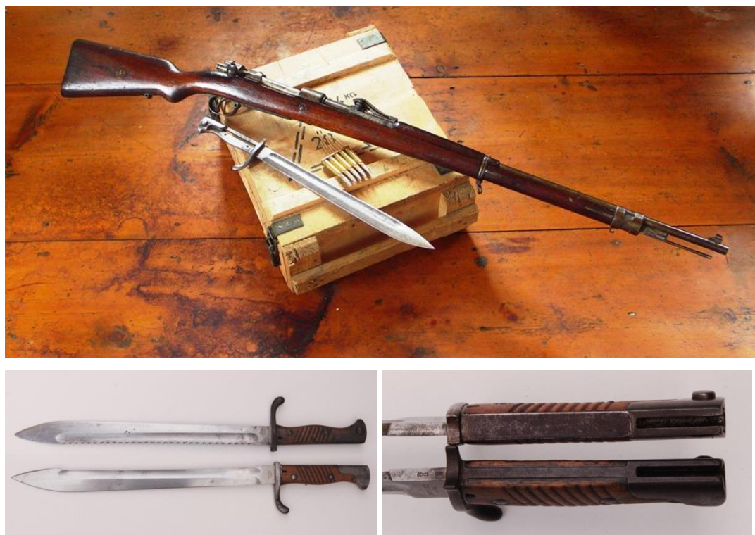
Afbeelding 55: Gewehr 98 met bajonet Seitengewehr 98/05 (boven). Bajonet met en zonder zaagtand (links onder) en met en zonder vuurbeschermer (rechts onder).
