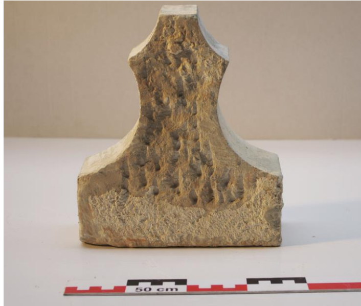
Figuur 116: Beitelsporen op een bouwsteen.
