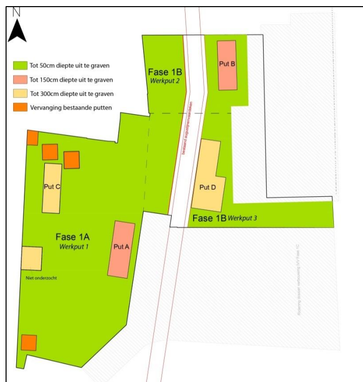
Figuur 2: Plangebied met uitgevoerde graafwerken
