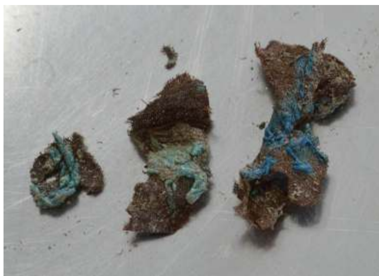
Foto 1: fragmenten waarop de gecorrodeerde metaaldraden duidelijk te zien zijn en waarop de blauwe draad aanwezig is. © KIK-IRPA, Brussel (laboratorium textiel)
