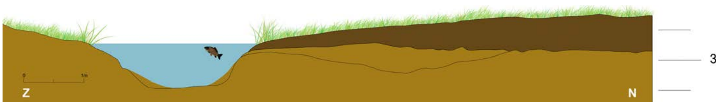
Reconstructie van het profiel in zone A tijdens de inundatiefase met een realistisch overstromingswaterpeil op 3m28 TAW en het profiel in een later stadium na ophoging van het inundeerbaar gebied.
