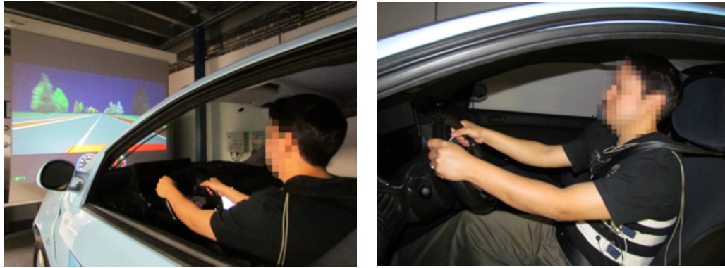
(a) Simulador de conducción: pantalla frontal y chasis del coche (b) El sujeto llevaba tres bandas RIP alrededor del abdomen, diafragma y pecho
