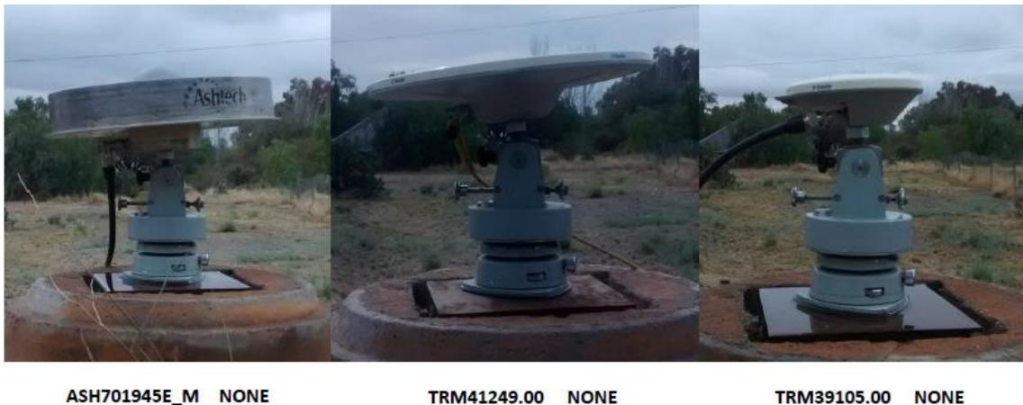
**Figura 3.** Antenas inclinación 5° (Ashtech Choke Ring, Trimble Zephyr Geodetic, Trimble Zephyr).
