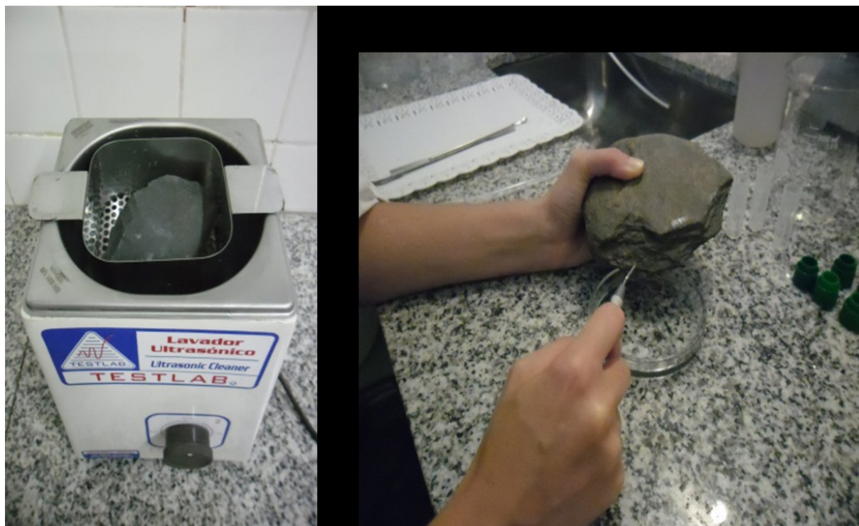
Figura 3. Técnicas de recuperación del conjunto microfósil. A la izquierda: lavado por ultrasonido. A la derecha: raspado mecánico de la pieza.
