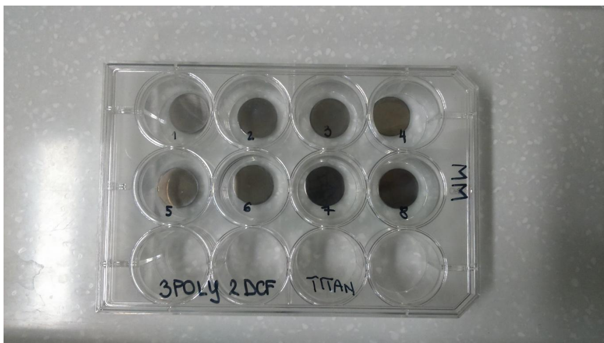
Slika 4-2 Ustrezno označeni obloženi vzorci v mikrotitrski ploščici
