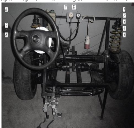
Рисунок 1. Стенд для дослідження параметрів гальмівних властивостей автомобіля : 1 – рама; 2 – стійка; 3- електродвигун; 4 – піввісь; 5 – колесо; 6 – кермо; 7 – рейка; 8 – шкала; 9 – гідронасос; 10 - манометр
