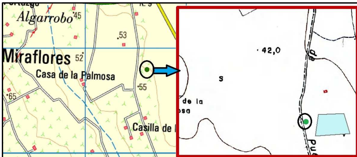
Fig. 2.3. Ejemplo de un error o desviación de ubicación respecto a la situación real
