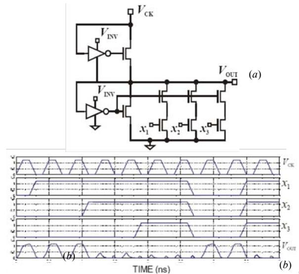
Figura 2: Puerta mayoritaria NMAJ<sub>3</sub> (a) Realización MOS-NDR disparada por flanco positivo (PET). (b) Simulación.
