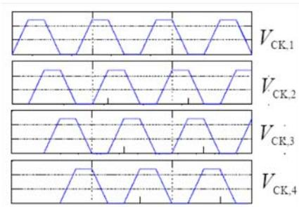
Figura 3: Esquema de reloj de cuatro fases solapadas.
