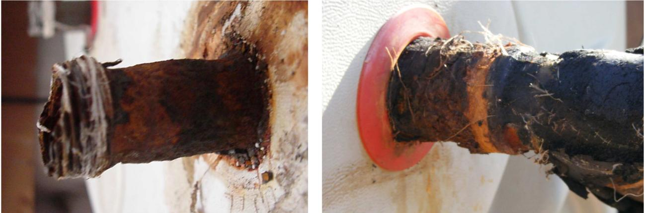
Figura 5-15. Corrosión bocas acumulador.
