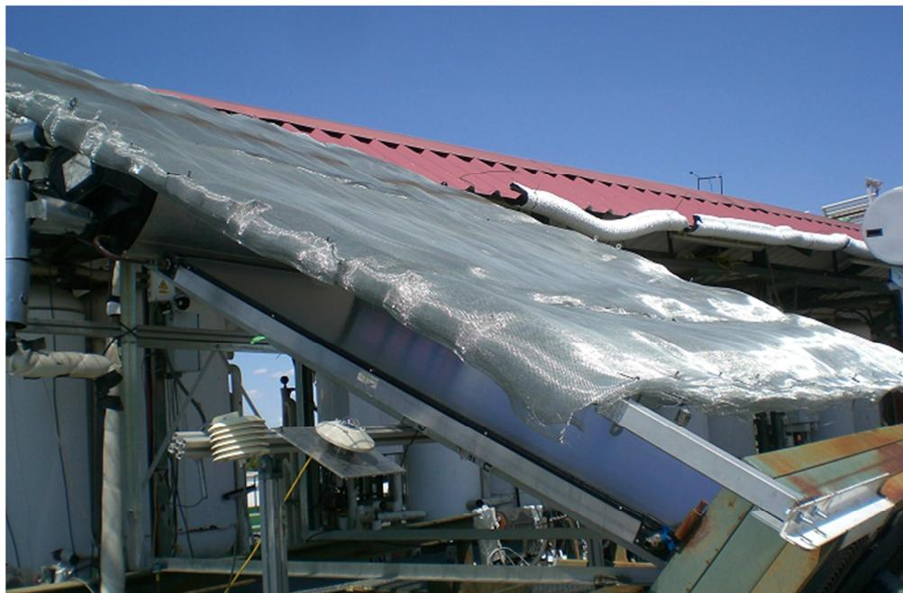
Figura 7-3. Vista lateral del dispositivo reductor de radiación solar
