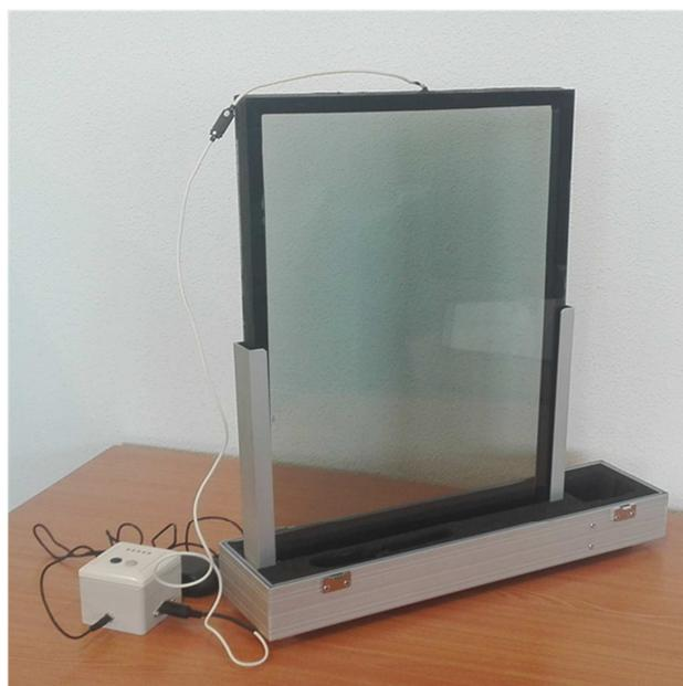
Figura 8-16. Muestra vidrio electrocrómico
