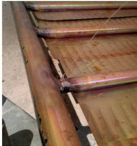
Figura 5-16. Rotura del captador por falta de mantenimiento del fluido anticongelante.
