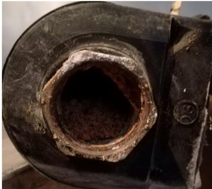
Figura 5-20. Depositiones de cal en el interior del captador
