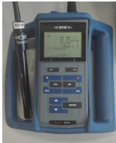
Figura 7-55. Conductímetro
