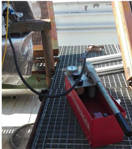
Figura 7-63. Bomba de presión hidráulica
