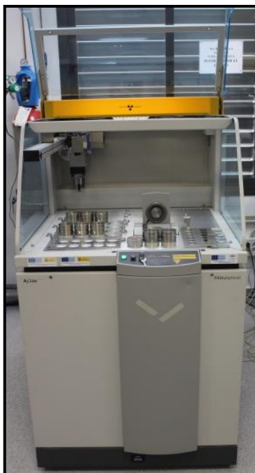
Figura 2.10. Imagen del espectrómetro de fluorescencia de rayos X empleado.
