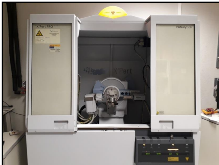
Figura 2.4. Imagen del equipo de difracción de rayos-X utilizado.
