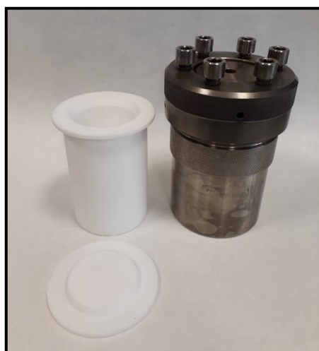
Figura 2.2. Imagen del reactor comercial usado en la síntesis hidrotermal.
