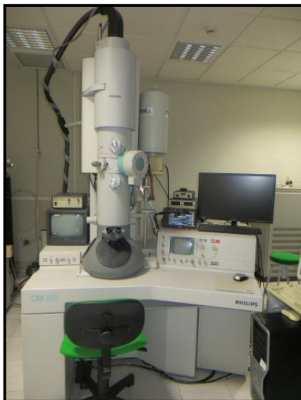
Figura 2.7. Imagen del equipo de microscopía electrónica de transmisión utilizado.
