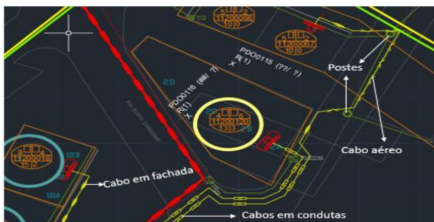
Figura 69 – Identificação dos cabos
