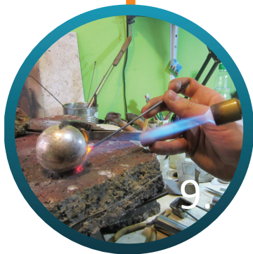
Soldado de las dos medias esferas con soldadura de plata
