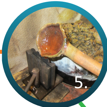
5. Vaciado en la lingotera
