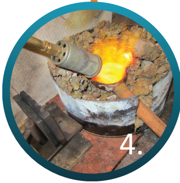
4. Fundición de la plata en crisol
