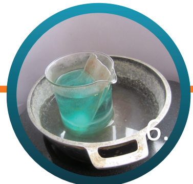
6. Limpieza del material fundido con alumbre potásico
