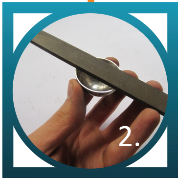
Limado e inspección
