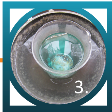
Limpieza e inspección de la esfera con alumbre potásico
