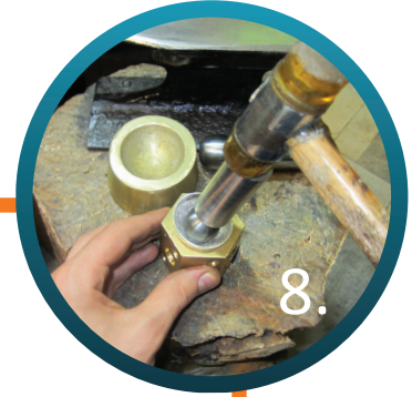
8. Martillado y moldeado en medias esferas
